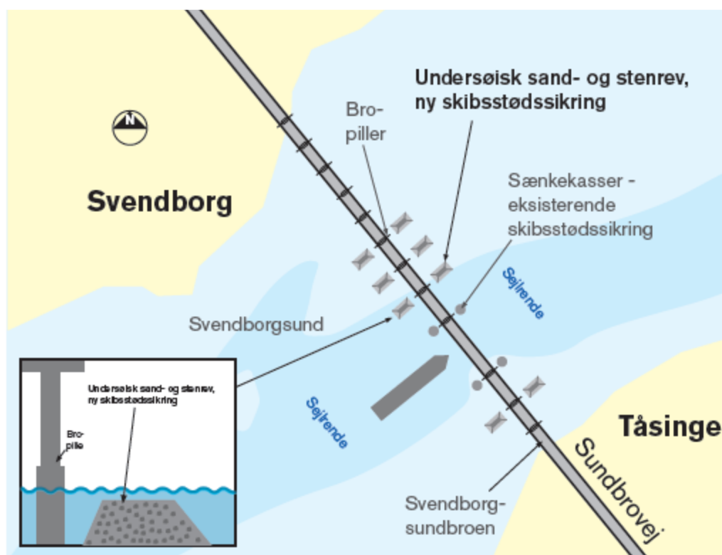
Principskitse viser placering af de kunstige stenrev
