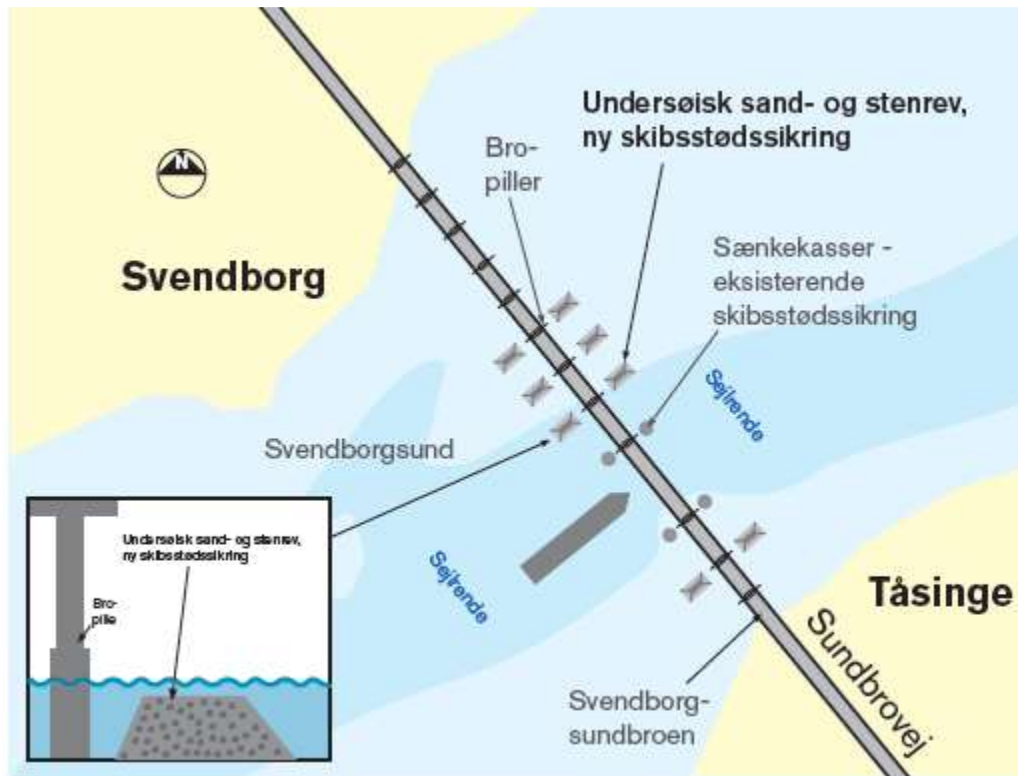
Principskitse viser placering af de kunstige stenrev
