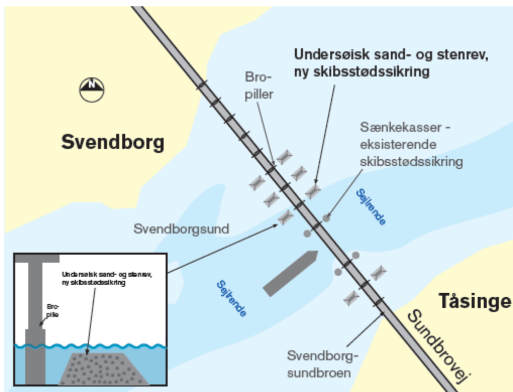
Principskitse viser placering af de kunstige stenrev
